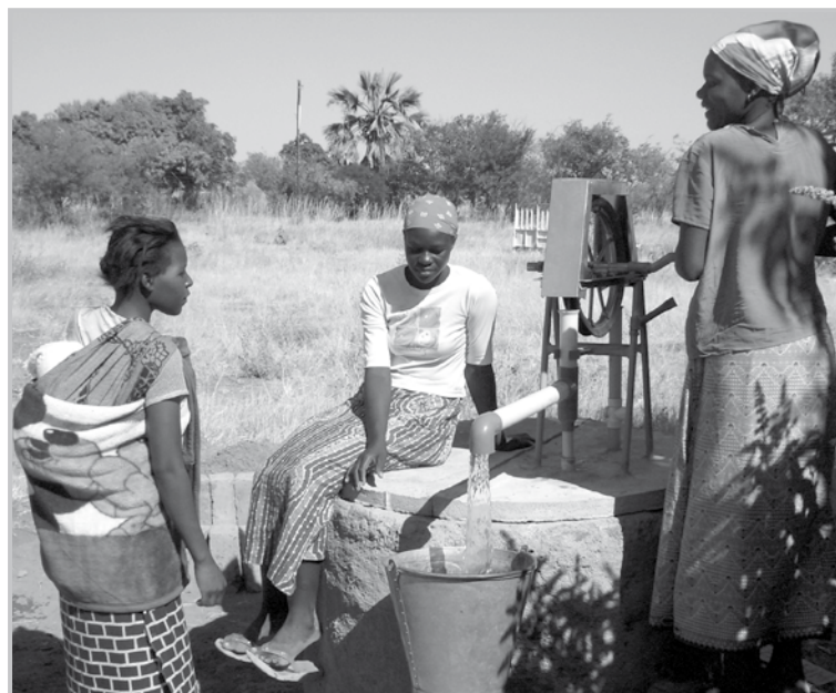
Bomba de corda feita localmente fornecendo água na Zâmbia
